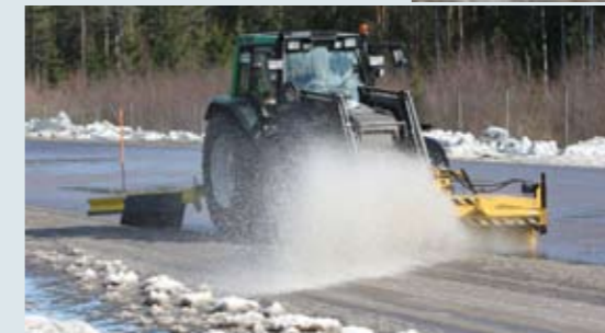
Unmittelbar vor der Messfahrt wird eine etwa 40 Zentimeter breite Spur mit definierter Matschhöhe angelegt
