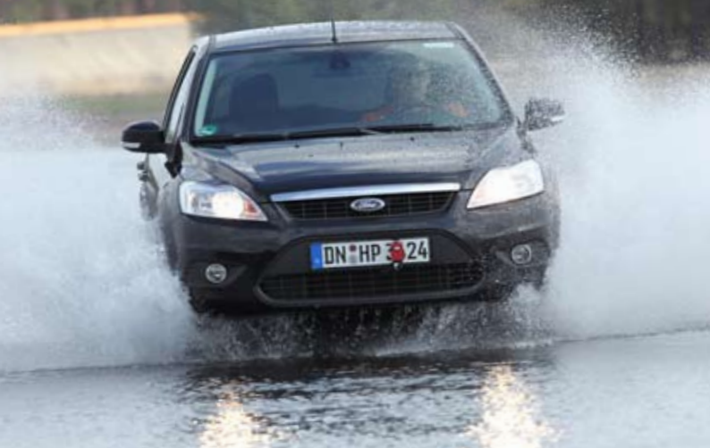
AQUAPLANING: Hochempfindliche Messelektronik offenbart, bei welchem Tempo der Ford Focus im Wasserbecken aufschwimmt
