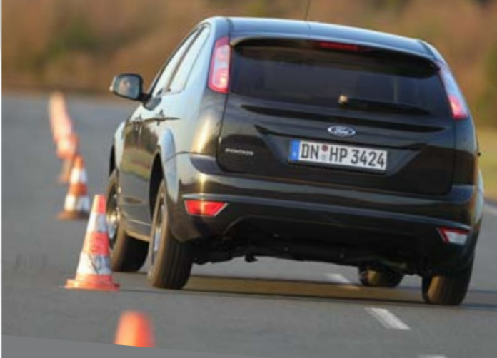
SLALOM: Die gezeitete Hatz um die Hütchen deckt eventuelle Schwächen im Lastwechselverhalten und der Lenkpräzision gnadenlos auf
