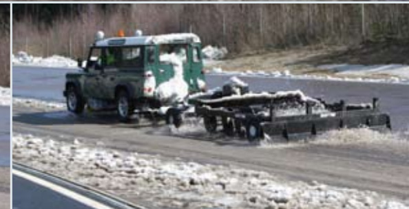
Speziell konstruierte Werkzeuge dienen der Präparation und verteilen den Schneematsch gleichmäßig
